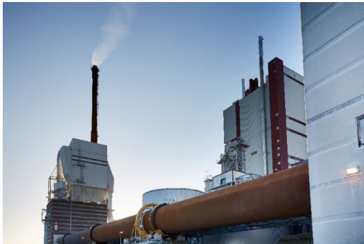
Drehrohrofen in der SCA-Fabrik Östrand (Bildnachweis: Behrendt und Rausch)
